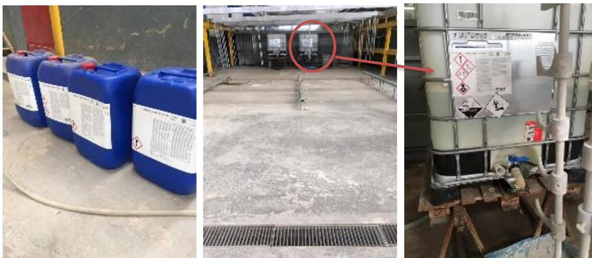
Figura 2. Armazenamento de produtos químicos junto à linha de tratamento de superfície (a foto do meio representa a grelha existente na linha de tratamento de superfície, cujos derrames são encaminhados para a tina de retenção existente sob a linha).
