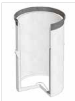
Figura 2 – Esquema da cuba de betão, incluindo o sistema integrado de remoção de líquidos
