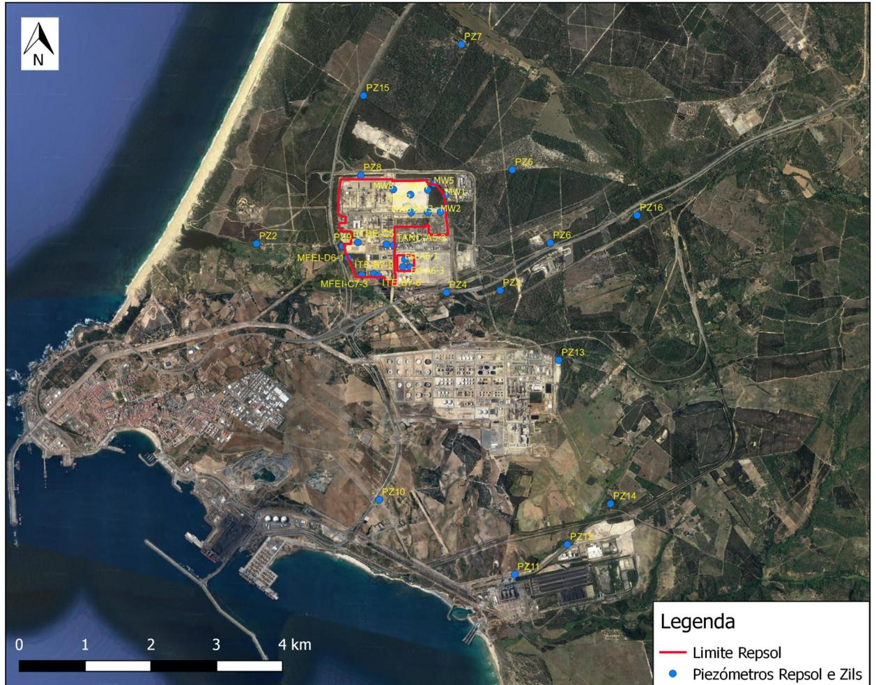
Figura 7 – Localização dos piezómetros no interior do perímetro fabril e na envolvente da REPSOL.
