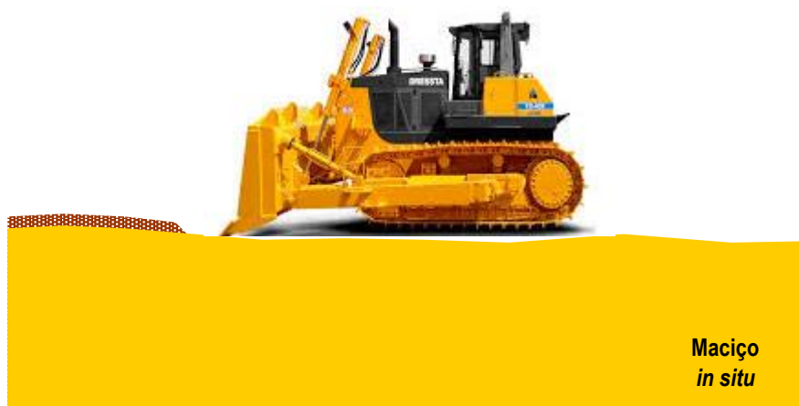
Figura II.3 – Técnica de remoção da terra vegetal.
