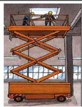
**Principais Tarefas:** Aparelho instalado nas carroçarias de veículos com motor, e constituído por uma plataforma (barquinha) ligada a uma estrutura elevatória geometricamente deformável.
