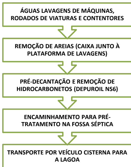
Figura 5 – Esquema de tratamento – águas residuais com hidrocarbonetos (2)
