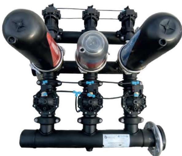
Figura 9 – Sistema de filtração e de elevação para a rega das pilhas
