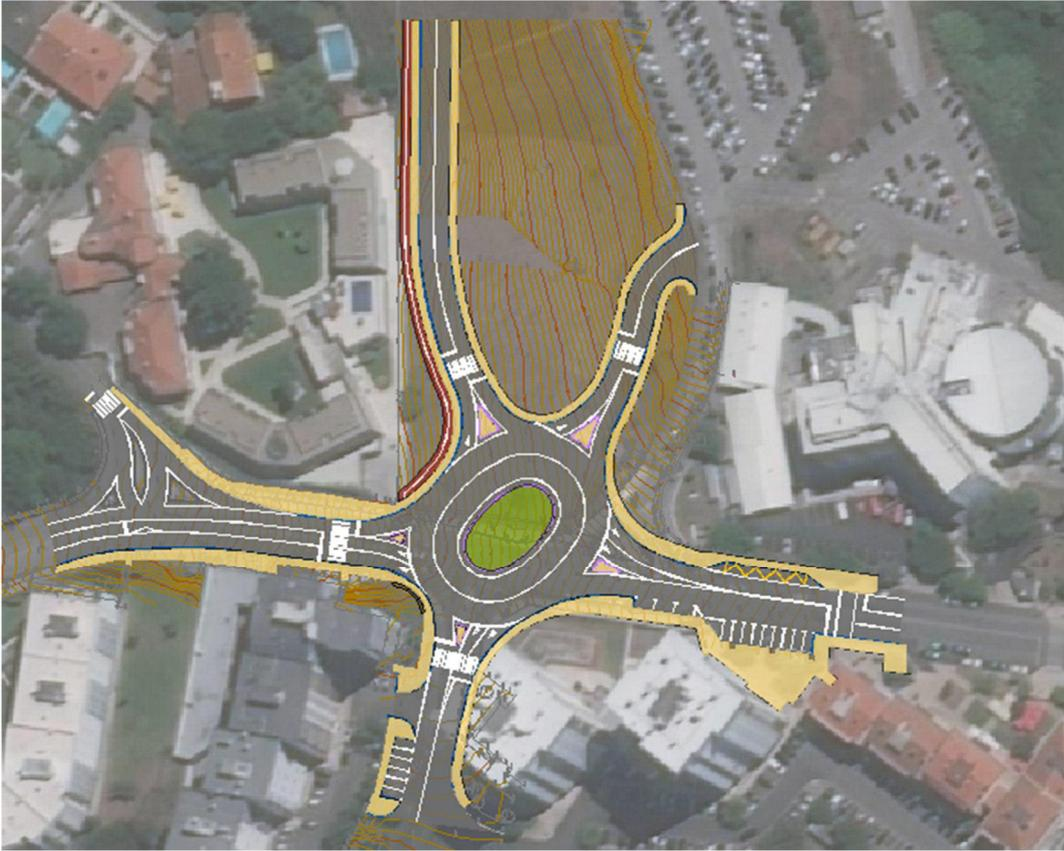
A solução proposta visa dotar a rotunda de acessos cómodos e seguros para os utilizadores rodoviários, assegurando um enquadramento adequado e harmonioso com a envolvente, tendo em consideração os condicionantes existentes e o tráfego expectável.
