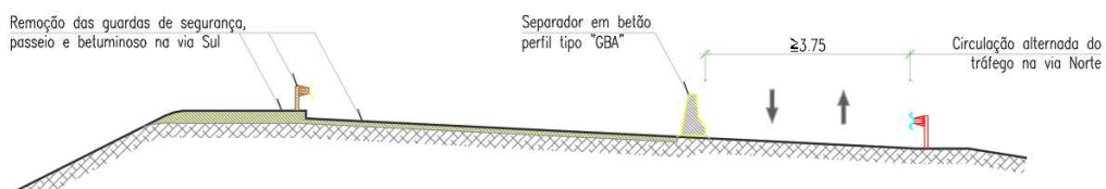
Figura 15 - Faseamento Construtivo - Fase 1
