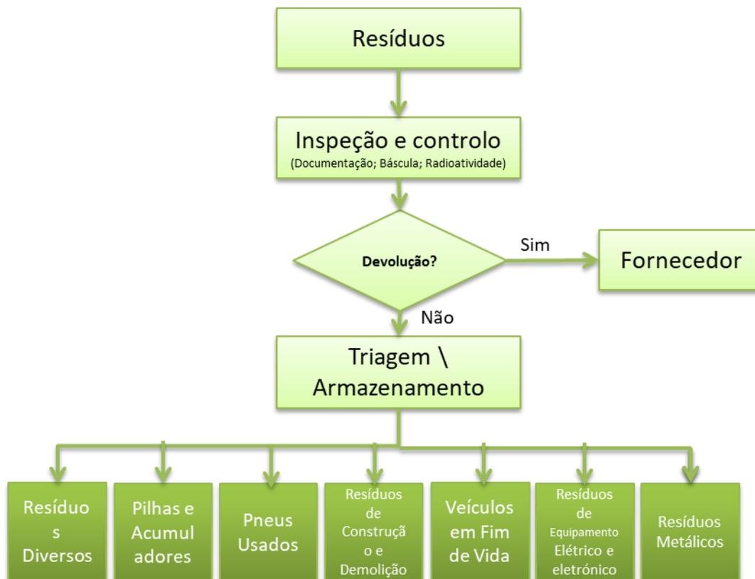
Figura 3 – Fluxograma da tarefa de inspeção e controle.
