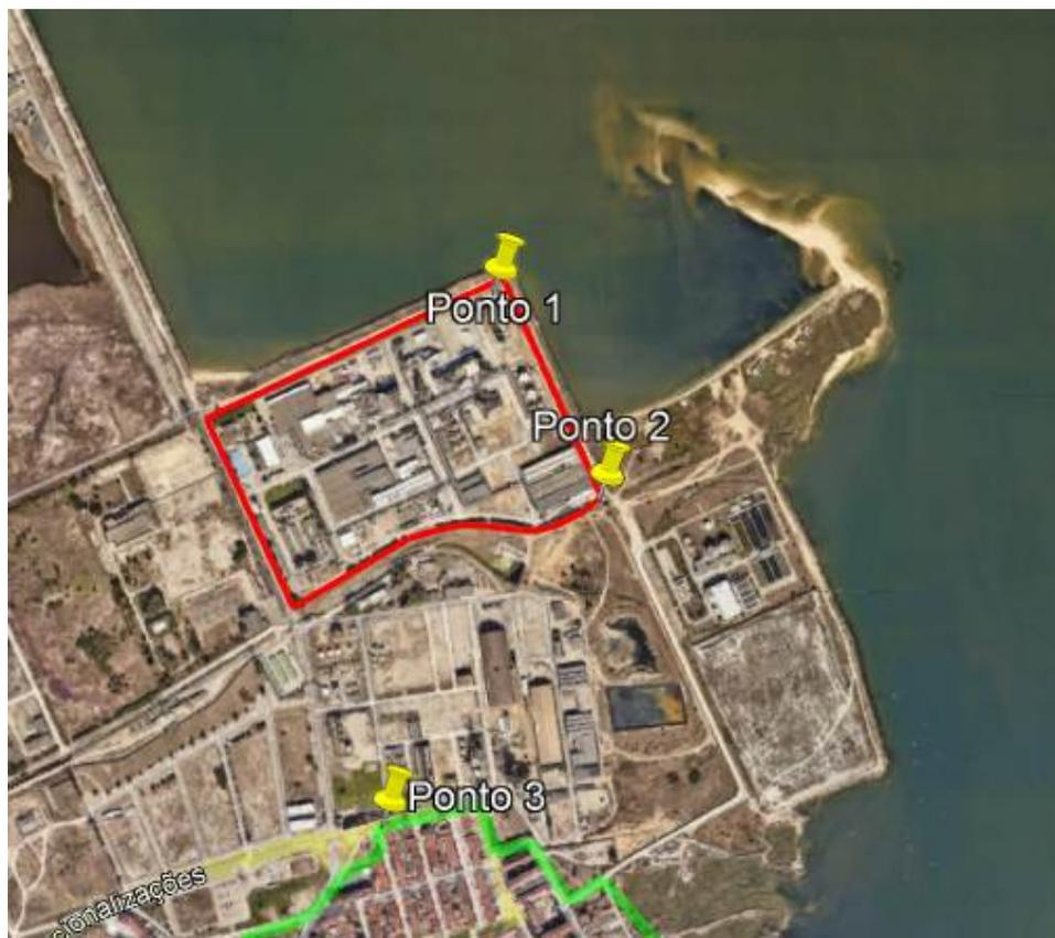
Os pontos de medição 1 e 2 ficaram localizados no interior do recinto da instalação, junto ao limite da mesma, por pedido do requerente (locais sem requisitos acusticos de ruído para o exterior).
