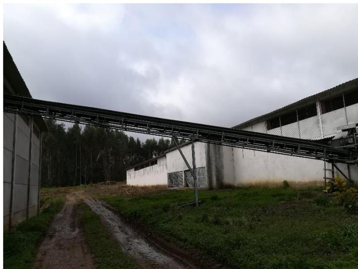
**Figura 7** – Tapete de transporte de estrume do pavilhão de produção para armazém próprio
