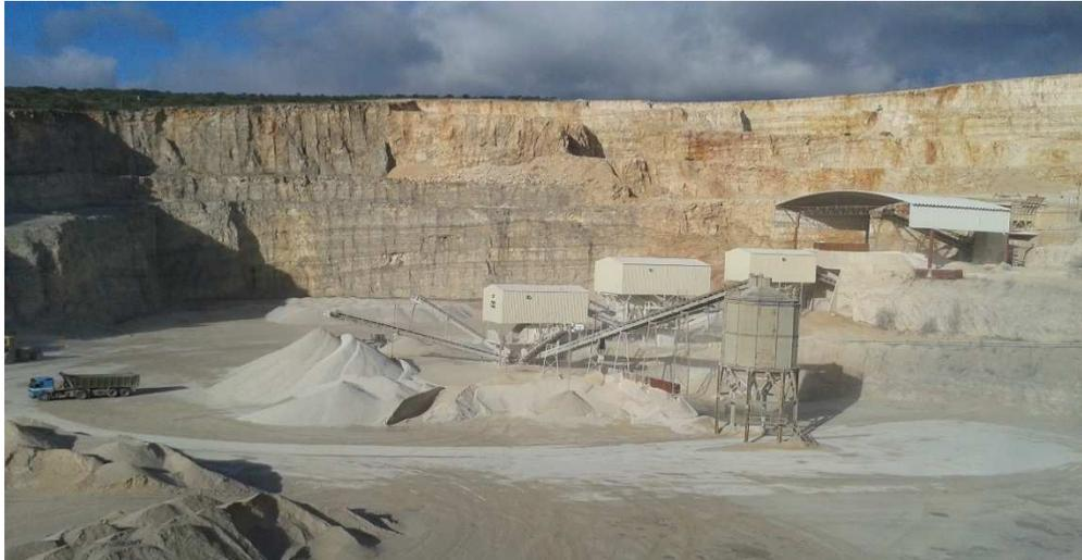
De um modo geral, os agregados produzidos são os *tout-venants* (calibre 0/32 mm), pedra para gabiões (calibre 90/180 mm), a britas graúdas (diversas gamas granulométricas entre os calibres 22/45 mm e 12/20 mm), as britas finas (diversas gamas granulométricas entre os calibres 10/20 mm e 4/6 mm) e um pó-de-pedra (refinado calcário, 0/4 mm e 0/2 mm).
