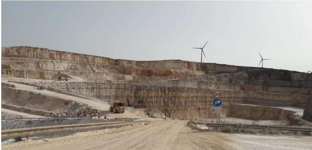
Após a detonação da pega de fogo iniciam-se as operações de remoção, carga e transporte dos fragmentos de rocha para a instalação de britagem e classificação de pedra que se encontra na pedreira.
