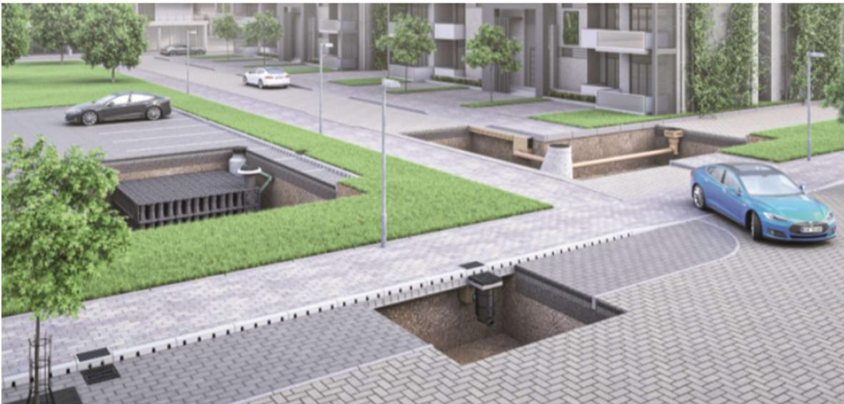
**Figura 9** – Sistema Stormbrixx em espaços transitáveis para laminar os picos de precipitação, [Fonte: ACO].
