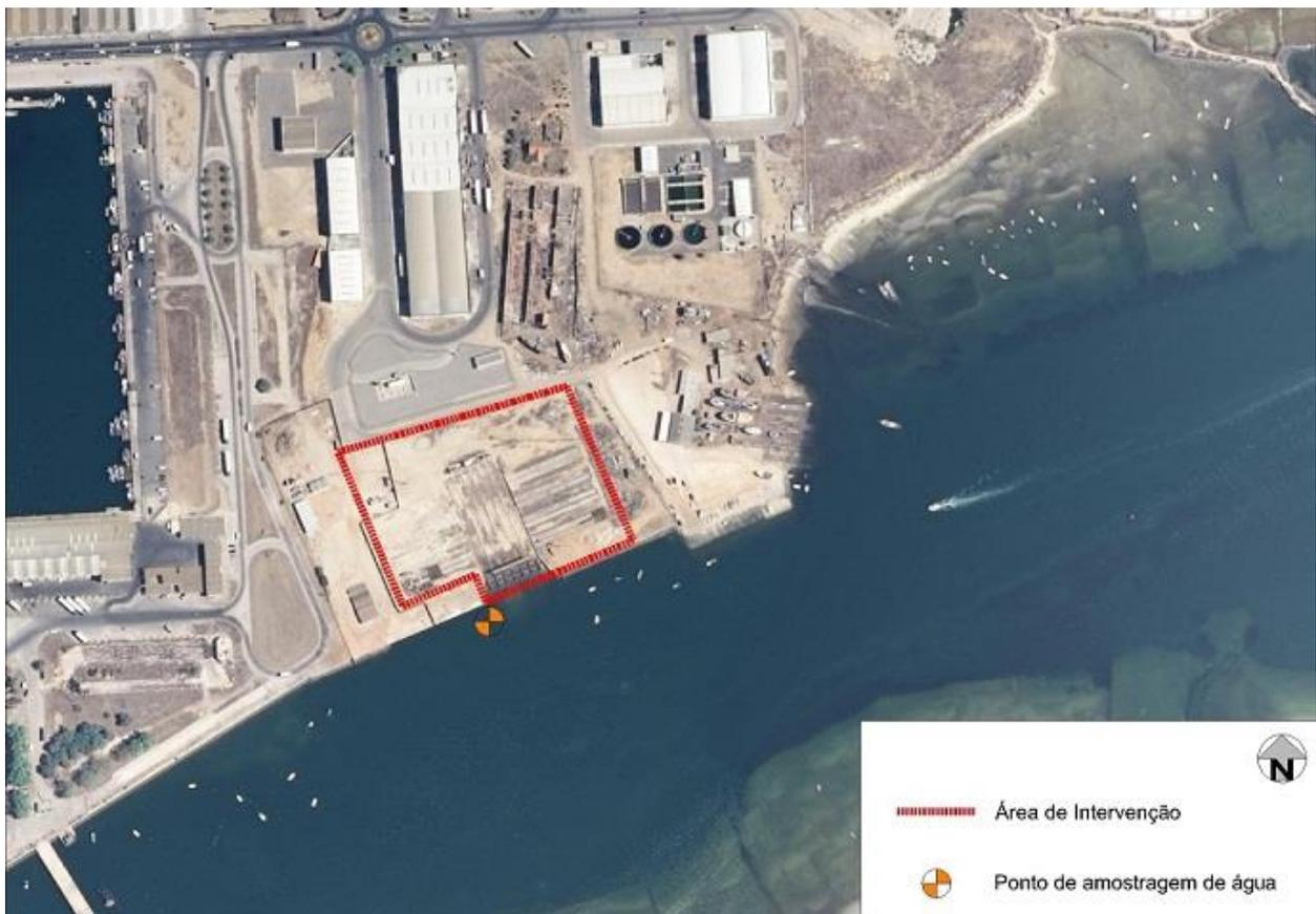
Segundo a empresa AmbiPar Control, será definida uma metodologia principal para amostragem de águas superficiais, em que, “a colheita de amostras discretas a 30cm abaixo da linha de água, recorrendo-se à amostragem direta por mergulho de vasilhame específico. Caso o volume de amostra necessário para a realização de todos os ensaios seja considerável, a recolha de amostra será realizada com frasco Van Dorn.
