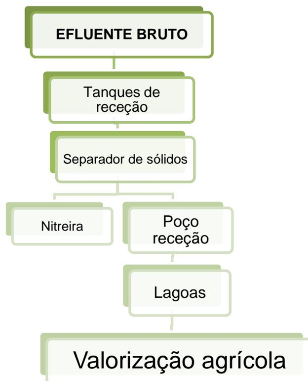
Figura 4- Diagrama da linha de tratamento da ETAR
