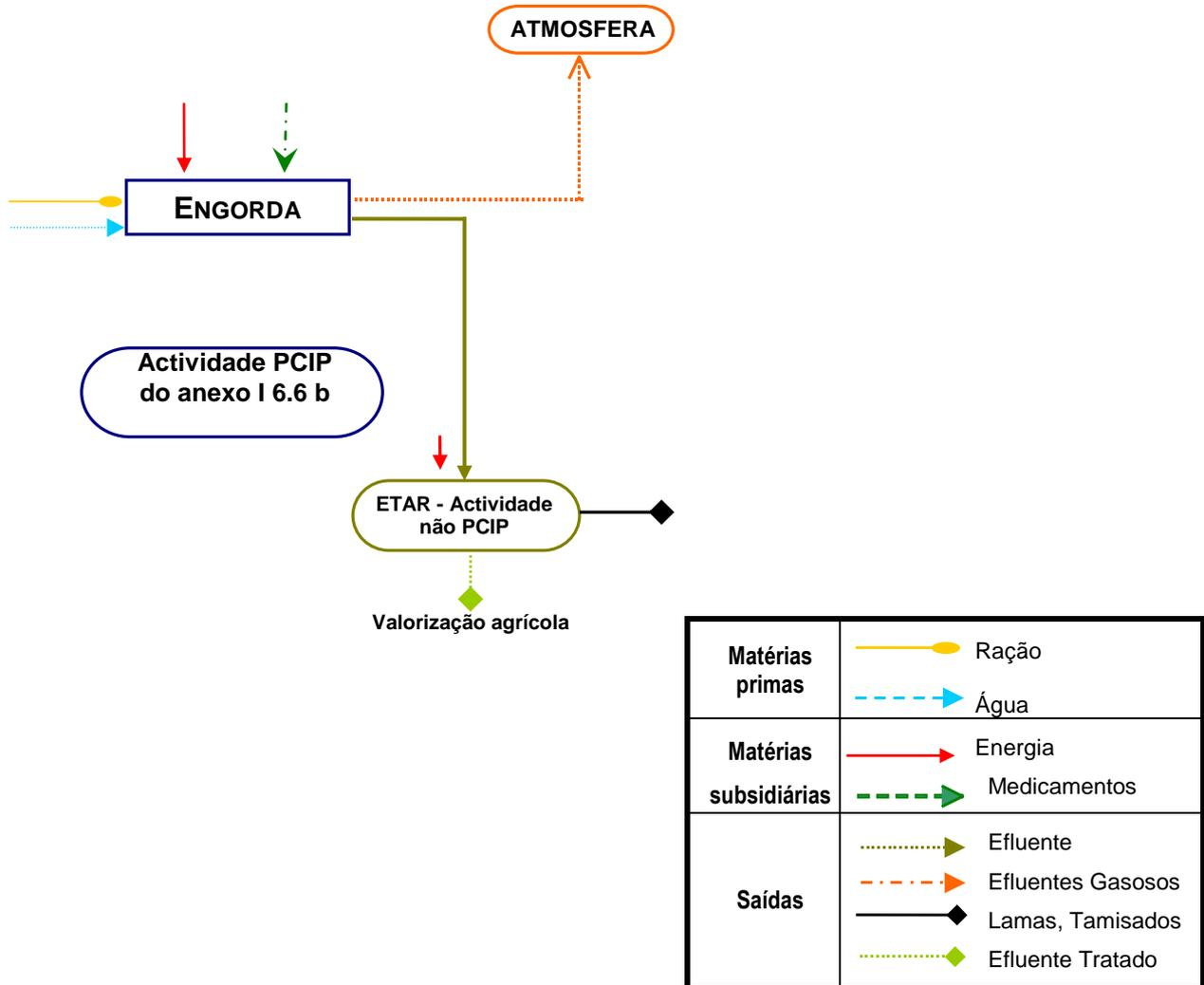
Figura 3 - Diagrama das entradas e saídas do sistema
