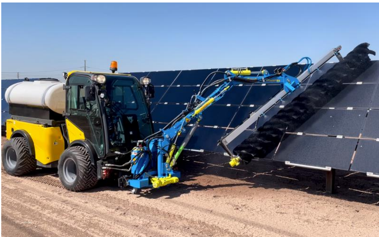
Figura 20: Imagem ilustrativa da limpeza dos painéis fotovoltaicos
