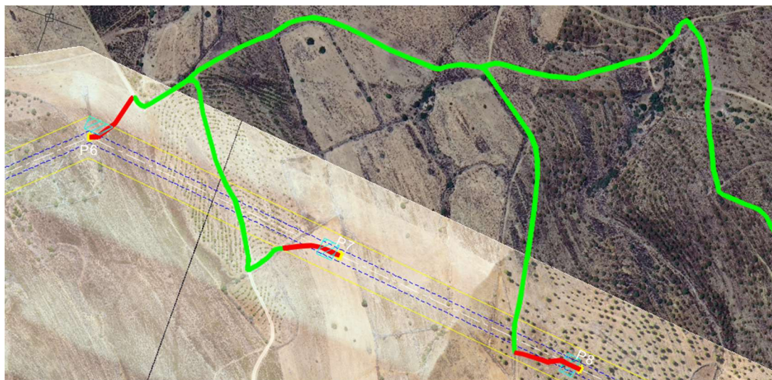
Figura 3.3.7 – Acessos aos apoios P6, P7 e P8
