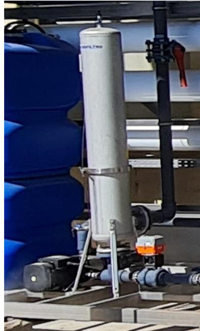
Figura 56- Representação gráfica e fotográfica da unidade de microfiltração de 5 micron
