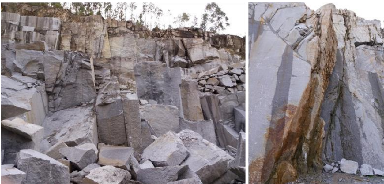
Figura 4-23 - Pormenor das diaclasses da família N50°-70°W (esquerda) e zona de falha com diaclasamento oblíquo e meteorização associados (direita).
